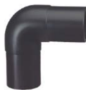
Kolano 90° PE 100 SDR 17 (ISO S8) 5 bar gaz / 10 bar woda
