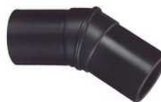
Kolana 30° i 15° PE 100 SDR 17 (ISO S8) 10 bar woda Kształtki zgrzewane segmentowo
