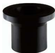
Tuleja kołnierzowa PE 100 SDR 11 (ISO S5) 10 bar gaz / 16 bar woda
