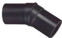
Kolana 30° i 15° PE 100 SDR 11 (ISO S5) 16 bar woda Kształtki zgrzewane segmentowo
