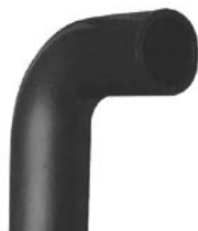
Łuk 90° PE 100 SDR 11 (ISO S5) 10 bar gaz / 16 bar woda Kształtki formowane od d 355 mm
