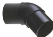
Kolano 45° PE 100 SDR 17 (ISO S8) 5 bar gaz / 10 bar woda
