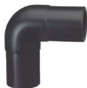
Kolano 90° PE 100 SDR 11 (ISO S5) 10 bar gaz / 16 bar woda
