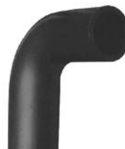
Łuk 90° PE 100 SDR 17 (ISO S8) 5 bar gaz / 10 bar woda Kształtki formowane od d 355 mm
