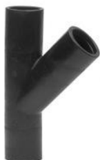
Trójnik 45° równoprzelotowy PE 100 SDR 11 (ISO S5) 10 bar gaz / 16 bar woda
